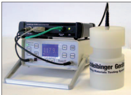
Fig 9. Equipo de Ultrasonidos para medida de las retracciones. A la dcha. Sensor de US para morteros, a su lado el aparato de medida y registro de la retracción; y encima el Datalogger (interface).
