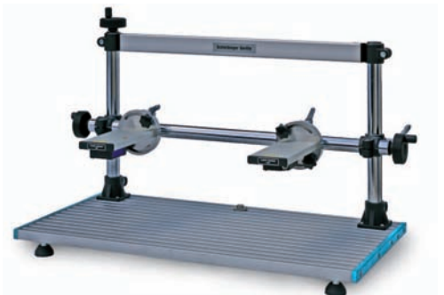
Fig. 8. Sistema de sujeción de los reflectores de medida de la retractibilidad de las capas finas a depositar sobre la base de la bancada.
